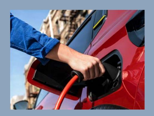
Recharge rapide 100 kW DC permettant une recharge allant de 20 à 80 % en 26 minutes.
